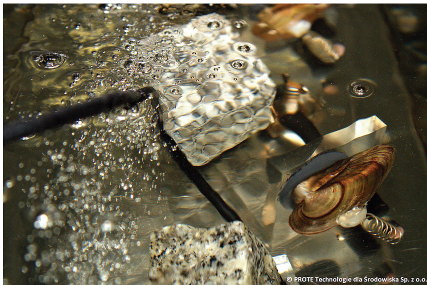
Małża wczesnego ostrzegania przed incydentalnym zanieczyszczeniem wody pitnej na SUW w Drzewcach.
